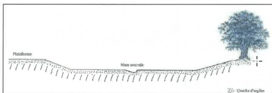
Figure 107 : Schéma de principe de l'aménagement d'une cuvette hydromorphe (Source : Pierre Dufrène)
